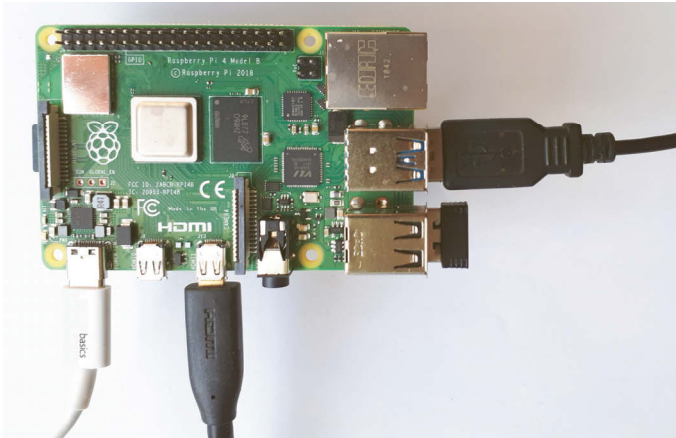
Abb. 1.11: RPi 3 mit angeschlossenen Geräten. Von links nach rechts: USB-C-Kabel zur Stromversorgung, Micro-HDMI-Kabel, Sender für Funktastatur und Maus kabel
